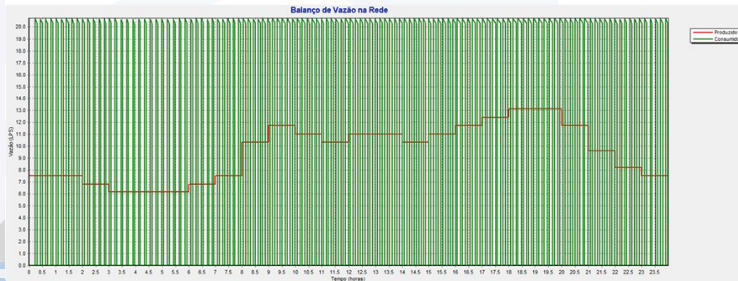
Figura 18 - Resultados do balanço de vazão no sistema ao longo de 24 horas de operação no dia de maior consumo – ETAPA 1
